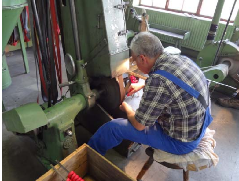
ภาพบรรยากาศการขึ้นรูปฟันหยัก (Micro serration)
