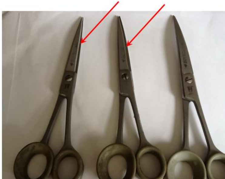
กรรไกรที่ถูกลับคมจากเครื่องลับกรรไกรที่ไม่ได้มาตรฐาน
